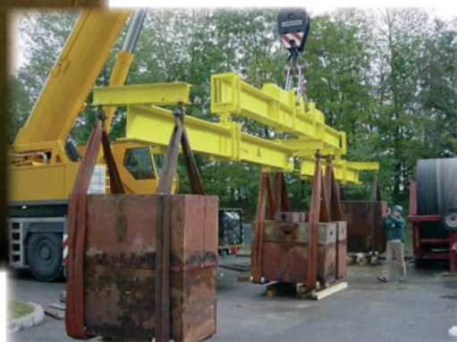
Essais en surcharge à 52 tonnes (150%). (CERN, Genève 2005)
