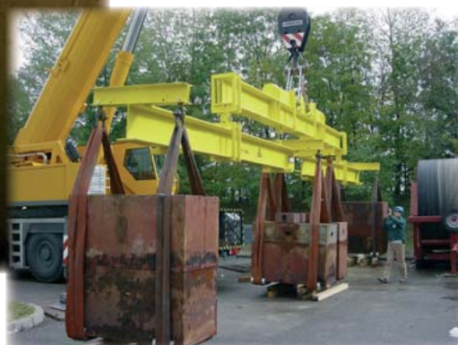
Essais en surcharge à 52 tonnes (150%). (CERN, Genève 2005)
