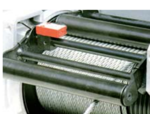
Interrupteur de mou de câble
