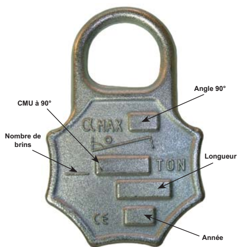
Plaquette N°2 TAG acier forgé ZINGUE
