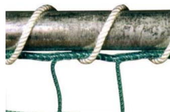
Cordes de fixation polyamide 8 mm ou polypropylène 10 mm
