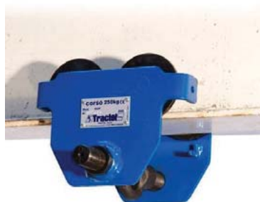
Chariot à direction par poussée
