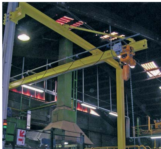
Pont roulant type posé
