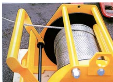
Interrupteur de mou de câble
